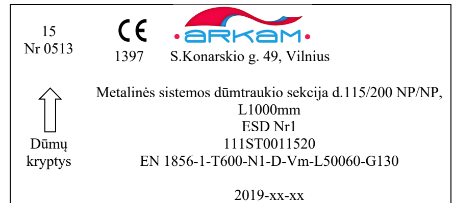
1 pav. Dvisienių dūmtraukių sistemos elementų ženklavimo pavyzdys
