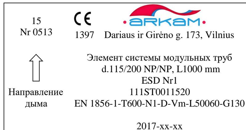
1 рис. Пример обозначения элементов системы модульных труб
