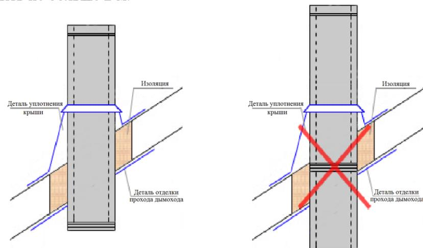
4 рис. Монтаж дымохода при пересечении конструкций здания
